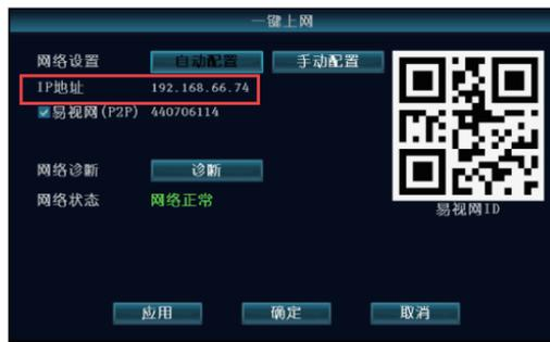
**步骤2:** 在同一局域网中计算机, 在IE或任一浏览器地址栏, 输入录像机内网IP和端口 (默认为80, 不用输入), 访问录像机内置网页, 然后输入用户名和密码登入。
